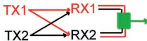
Il semplice schema che descrive la quadrupla diversità impiegata nel sistema ACE-HIGH: l'elemento verde rappresenta il combinatore che seleziona sempre il canale migliore che sarà ritrasnesso
