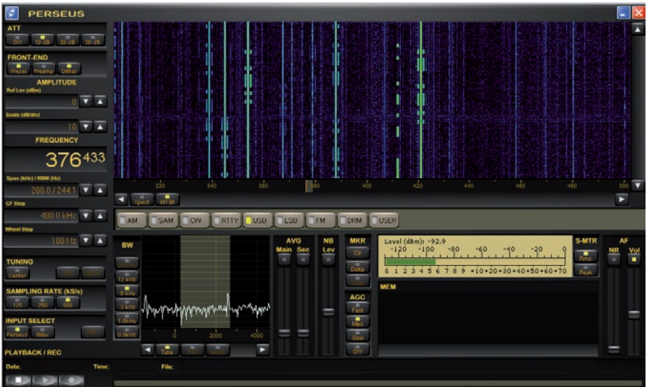
Il segnale CW degli NDB leggibile sul waterfall di Perseus
